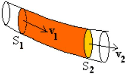
On considère une masse fluide circulant dans une conduite forcée (sous pression), délimitée par les sections  $S_1$ ,  $S_2$  et la paroi intérieure de la conduite.
